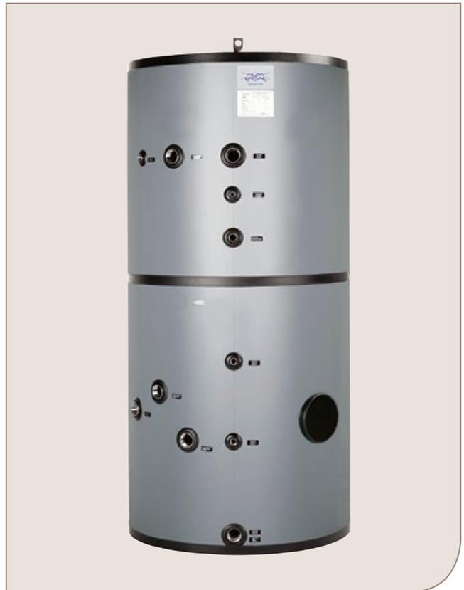
Поступающая в бак холодная вода плавно распределяется по нижней части емкости, не перемешиваясь с горячей водой, всегда находящейся в верхней части бака. Вертикальные накопители при этом значительно более эффективны, поэтому и AquaTank имеет вертикальную цилиндрическую форму.
